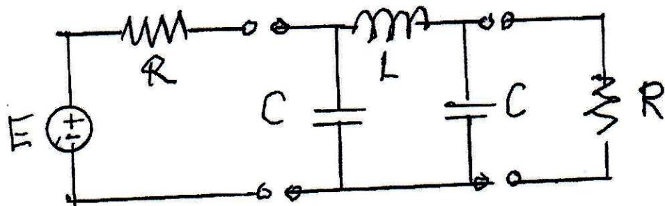
$$V_1 = AV_2 - BI_2 \quad I_1 = CV_2 - DI_2$$
